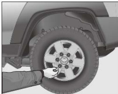
Beim Eindrehen der Radmuttern zunächst die Radmuttern mit der Hand festziehen. Drücken Sie danach das Rad auf die Bremsscheibe, um festzustellen, ob es noch stärker angezogen werden kann.
