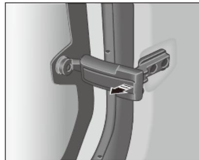
1. In Richtung des -Pfeils-, wie in der Abbildung dargestellt, ziehen sie den Verschlussgriff des Fahrzeugfensters, um die Positionsverschließung aufzuheben.
