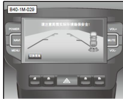
Die roten, gelben und grünen Linienblöcke sind statische Linienblöcke, sie zeigen den Abstand zwischen dem Heck und dem Reserverad an. Die Breite sollte etwas größer sein als die Fahrzeugbreite.
