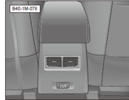
Um die Richtung des Luftflusses einzustellen, drehen sie die gewölbte Zunge in der Mitte des Luftaustritts nach oben oder unten und nach links oder rechts.
