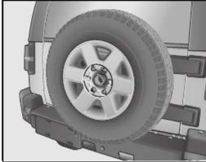
4. Richten sie die Bohrungen des Ersatzrades auf den Stehbolzen der Bremsscheibenmitte aus.
