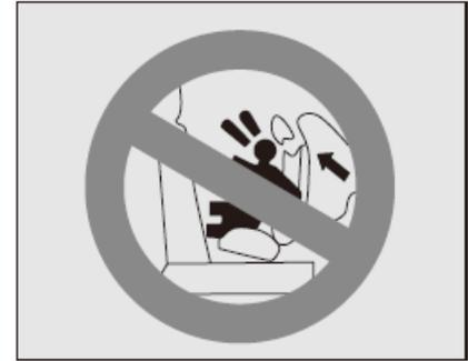
Bringen sie einen Kindersitz NICHT, nach hinten zeigend, auf dem Beifahrersitz des Fahrzeuges an. Bei Auslösung und Ausbreitung des Airbags, wenn sie ihn so angebracht haben sollten, wird ihn, mit extremer Wucht, auf der Rückseite des Kinderschutzgerätes aufprallen lassen und dies kann zu ernsthaften Verletzungen und sogar zum Tode des Kindes führen.
