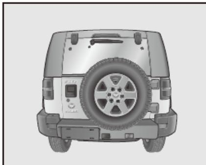
Das Reserverad befindet sich auf dem Reserveradrahmen der Hecktür. Um diesen zu verwenden, entfernen sie ihn bitte entsprechend der folgenden Schritte:
