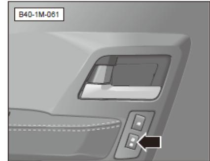
Knöpfe am zentralen Türverschluss der Fahrertüre, wie in der Abbildung dargestellt. Drücken sie den Knopf nach oben, um das zentrale Türverschlussystem zu entriegeln und herunter, um es zu verriegeln.
