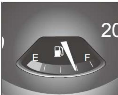
Die Kraftstoffanzeige befindet sich unterhalb des Geschwindigkeitsmessers. Wenn der Zündschlüssel in die „ON“-Position gedreht wird, zeigt die Kraftstoffanzeige die Menge des verbleibenden Kraftstoffes im Kraftstofftank an. Von „E“ bis „F“ zeigt es die Änderung in der Kraftstoffmenge im Kraftstofftank an, von Leer bis Voll. Wenn der Zündschlüssel sich nicht in der „ON“-Stellung befindet, so kehrt die Anzeige in die „E“-Stellung zurück.
