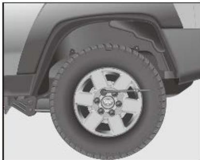
Vor dem Anheben des Fahrzeugs, lösen sie zuerst die Radmuttern.
