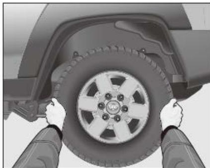
Richten sie die Bohrungen des Reserverades nach den Stehbolzen der Bremsscheibe aus.
