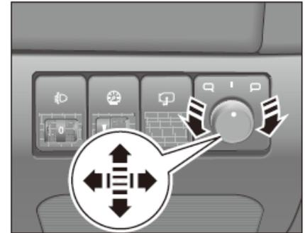
Die externen Rückspiegel werden durch die Einstellschalter der Rückspiegel gesteuert. Der Einstellschalter der Aussenspiegel befindet sich auf der Fahrerseite des Armaturenbretts.
