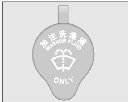
Die Scheibenwaschflüssigkeit der Windschutz- und Heckscheibe wird von einem Scheibenwasserbehälter im Motorenraum geliefert. Wenn festgestellt wird, dass der Scheibenwaschwasserstand zu niedrig ist, stellen sie sicher sofort Waschflüssigkeit im Vorratsbehälter aufzufüllen.
