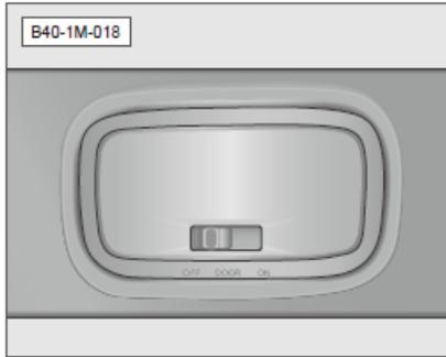
Die Leseleuchte befindet sich auf der Mittellinie des Fahrzeughimmels. Wie in der Darstellung angezeigt, verfügt die Leseleuchte insgesamt über 3 Positionen:
