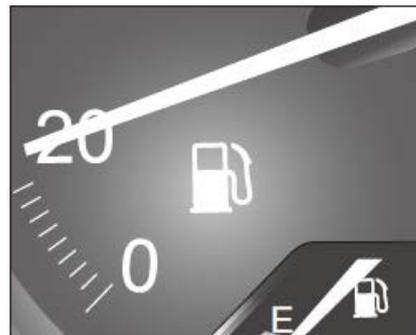
Die Kraftstoffwarnleuchte befindet sich bei der Geschwindigkeitsanzeige. Wenn der verbleibende Kraftstoffstand im Kraftstofftank niedrig ist, alarmiert sie den Fahrer betreffs der Notwendigkeit des Auftankens. Zusätzlich erscheint eine Warnnachricht auf dem Anzeigebildschirm des Informationszentrums, siehe Seite 063 „Warnung Anzeigeleuchte“.
