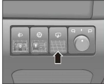
Wie in der Darstellung dargestellt, befindet sich der elektrische Anklappschalter, auf der Fahrerseite, in der Schalteranordnung des Armaturenbrettes.
