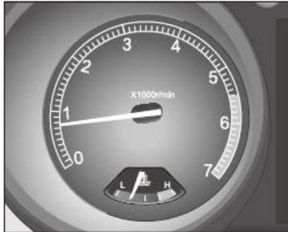
Die Anfangsseite des Drehzahlmessers zeigt die maximal erlaubte Drehzahl des Motors an. Erst nachdem der Motor normal eingearbeitet wurde und seine normale Arbeitstemperatur erreichte, kann er bei der Maximaldrehzahl betrieben werden.
