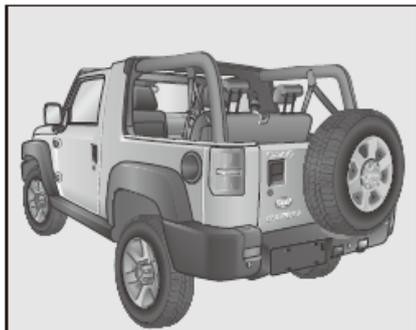
3. Heben sie die Dachpaneele leicht an und bewegen sie diese in Richtung des hinteren Fahrzeugteils.
