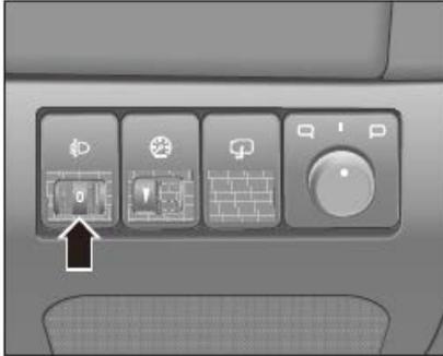
Der Winkel der Abblendlampen hängt von der Gewichtsverteilung der Insassen und deren Gepäck ab. Stellen sie die Scheinwerfer derart ein, dass die Strasse vor dem Fahrzeug ausreichend beleuchtet wird, ohne den entgegenkommenden Verkehr zu blenden. Wie in der Abbildung dargestellt, befindet sich das Höheneinstellrad der Scheinwerfer auf der Armaturenbrettanordnung.
