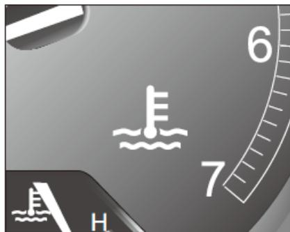
Die Warnleuchte (rot) der Motorenkühlung befindet sich bei der Tachoeinheit. Bei zu heißem Kühlwasser leuchtet diese Anzeige auf. Zu diesem Zeitpunkt, sollten sie, so schnell wie möglich, ihr Fahrzeug an einem entsprechenden Ort parken, die Zündung ausschalten, den Kühlwasserstand überprüfen und nachsehen ob eine Undichtigkeit in der Kühlwasserleitung vorhanden ist.
