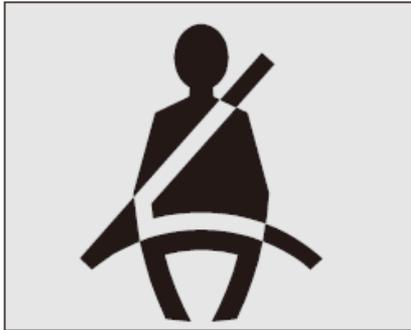
Beim Betätigen der Zündung, wenn der Fahrer nicht seinen Sicherheitsgurt angelegt haben sollte, leuchtet eine „Sicherheitsgurt anlegen“-Warnleuchte auf der Armaturenanzeige auf. Die Warnleuchte wird sofort erscheinen, begleitet von einem hörbaren Signal. Dieses ertönt wenn der Fahrer nicht seinen/ihren Sicherheitsgurt angelegt hat und die Fahrzeuggeschwindigkeit 25 km/h übersteigt, eine Bewegung von mehr als 500 m aufweist oder für mehr als 60s eine Geschwindigkeit von unter 25 km/h stattfindet.
