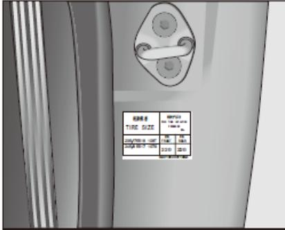
Ein Informationsetikett betreffs des Reifens ist auf der B-Säule an der Fahrerseite aufgeklebt. Stellen sie sicher die Reifen entsprechend des auf dem Etikett angegebenen Reifendrucks aufzupumpen.
