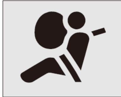
Die Fehlerwarnleuchte in der Instrumenteneinheit des Armaturenbrettes wird ihnen jegliches Versagen des Airbags und der Spannvorrichtung des Sicherheitsgurtes anzeigen.
