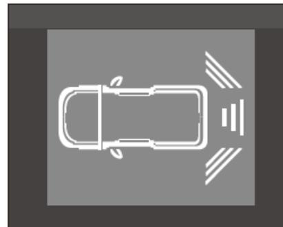
3. Ein Anzeigestreifen zeigt an, dass der Abstand zwischen dem Fahrzeug und dem Hindernis ca. 30 bis 60 cm beträgt.
