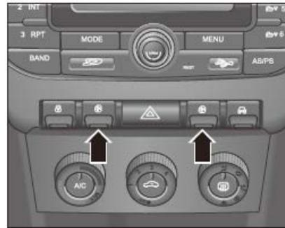
Wie in der Abbildung dargestellt befindet sich der elektrische Fensterheberknopf in der Anordnung der Kombinationsknöpfe der Mittelkonsole.
