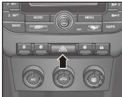
Wie in der Abbildung dargestellt, befindet sich der Warnleuchterschalter in der zentralen Kontrollleuchtenanordnung.
