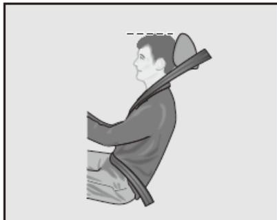
Stellen Sie die Kopfstütze ein, dass die Oberkante der Kopfstütze so hoch ist wie die Oberseite des Kopfes, und die Rückseite des
