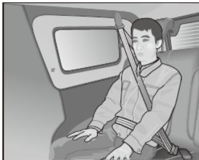
Entsprechend der Notwendigkeit, stellen sie die Kopfstütze des hinteren Sitzes ein, sitzen sie aufrecht auf der hinteren Sitzbank und passen sie ihren Rücken der hinteren Kopfstütze so gut wie möglich an. Ziehen sie den Sicherheitsgurt in der oberen Hälfte der naheliegenden Säule aus der Aufrollvorrichtung, schieben sie die Lasche in das Schloss ein und ziehen sie den Gurt fest am Körper an. Beim Befestigen der Lasche im Schloss ertönt ein klickendes Geräusch.
