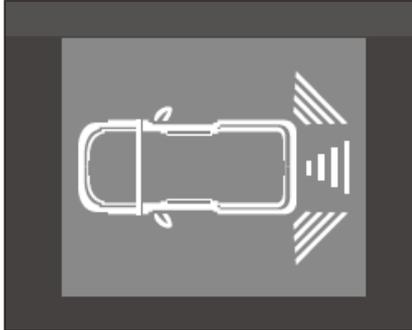
4. Ein Anzeigestreifen zeigt an, dass der Abstand zwischen dem Fahrzeug und dem Hindernis geringer als 30 cm ist.
